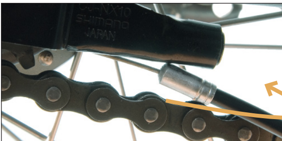
Montering af gearkabel
