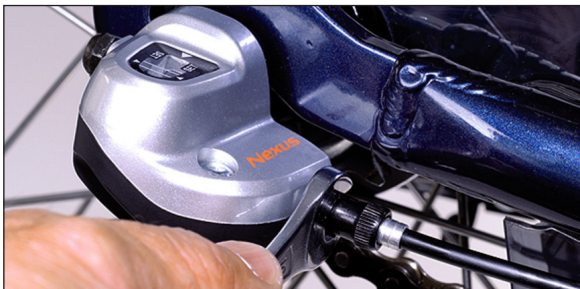
Justering af gearkabel
